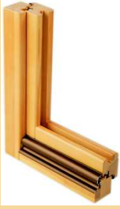
Serramento esterno in legno lamellare modello "ENERGANDER" Vetro 44.1 Stadip Silence 14 Argon 4 14 Argon 33.1 b.e. Con canal. Chroma Ug= 0,6 psi= 0,04
